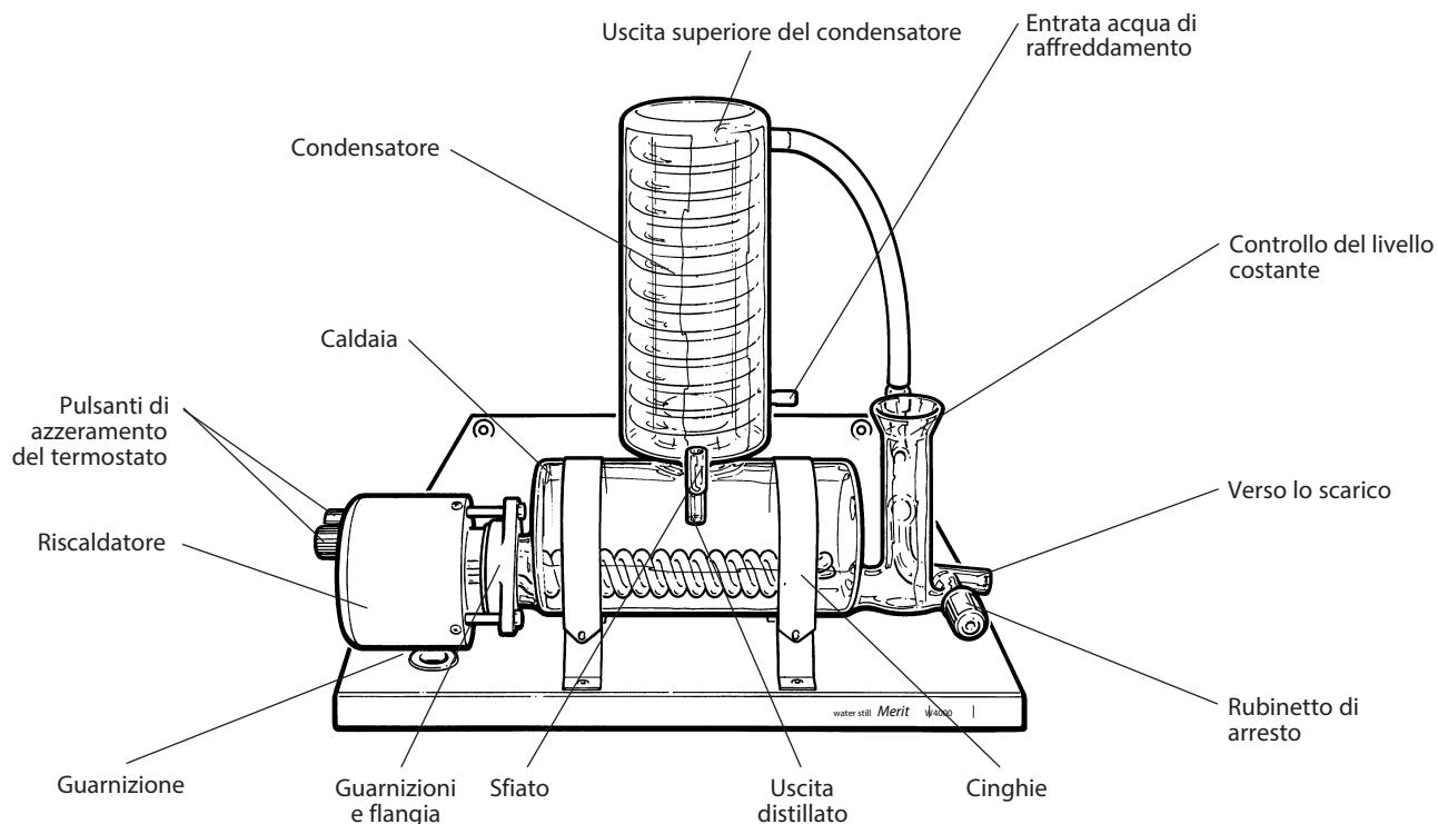
Figura 1 Montaggio generale
