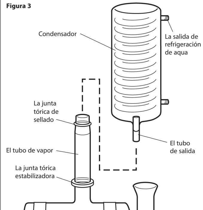
6. En el kit de tubos, coja el tubo de plástico de 225 mm de longitud y 8 mm de diámetro que tiene las uniones roscadas en los dos extremos. Según la Figura 1, rosque un extremo del tubo en la salida superior del condensador, y el otro extremo en la rosca de vidrio del control de nivel constante. Si el alambique está montado correctamente, el tubo debe llegar cómodamente, sin tensiones.
