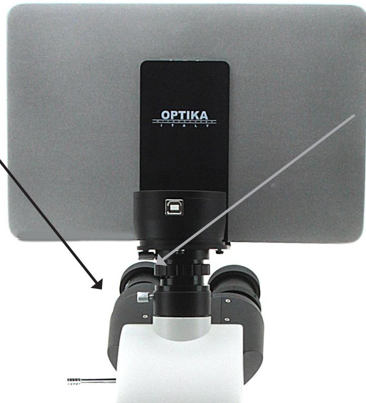
**2. COLOQUE LA CÁMARA CON EL ADAPTADOR AL TUBO TRINOCULAR Y FIJAR CON EL TORNILLO.**
