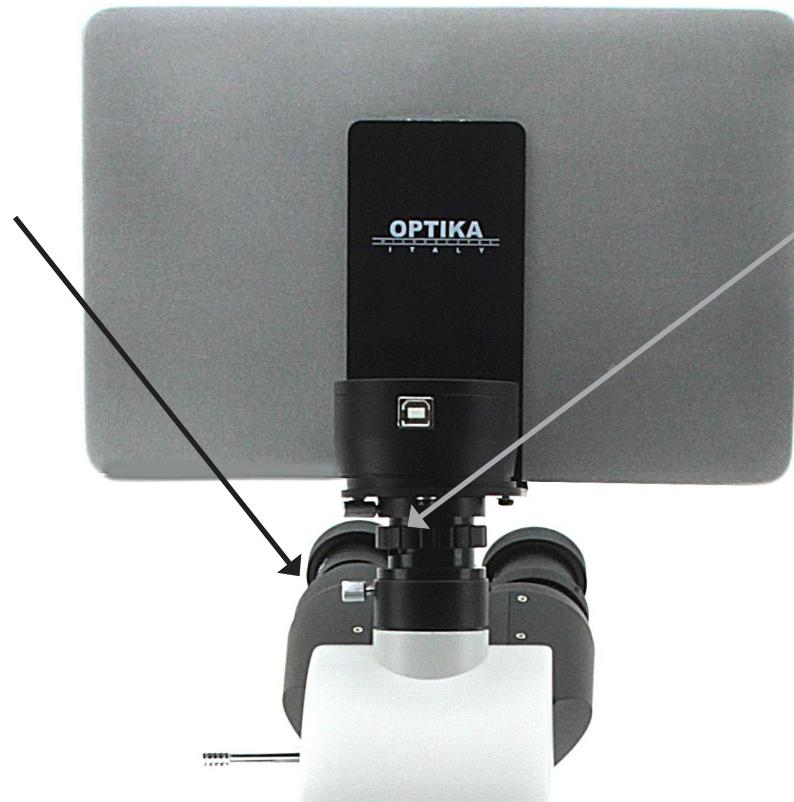
**2. LEGEN SIE DEN MONTIERTEN ADAPTER AN DAS FOTO-PORT UND SCHRAUBEN SIE**
